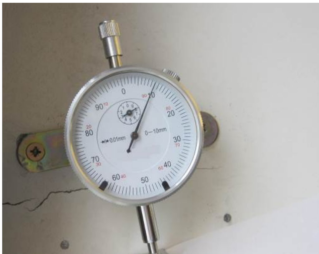
Фото 12. Фотофиксация показаний маяка (индикатора-щелемера) (замер б) _____ Г.
