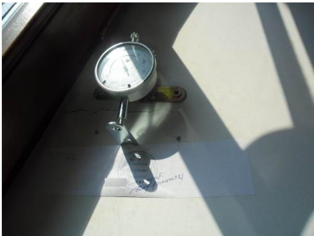
Фото 11. Фотофиксация показаний маяка (индикатора-щелемера) (замер б) _____ Г.
