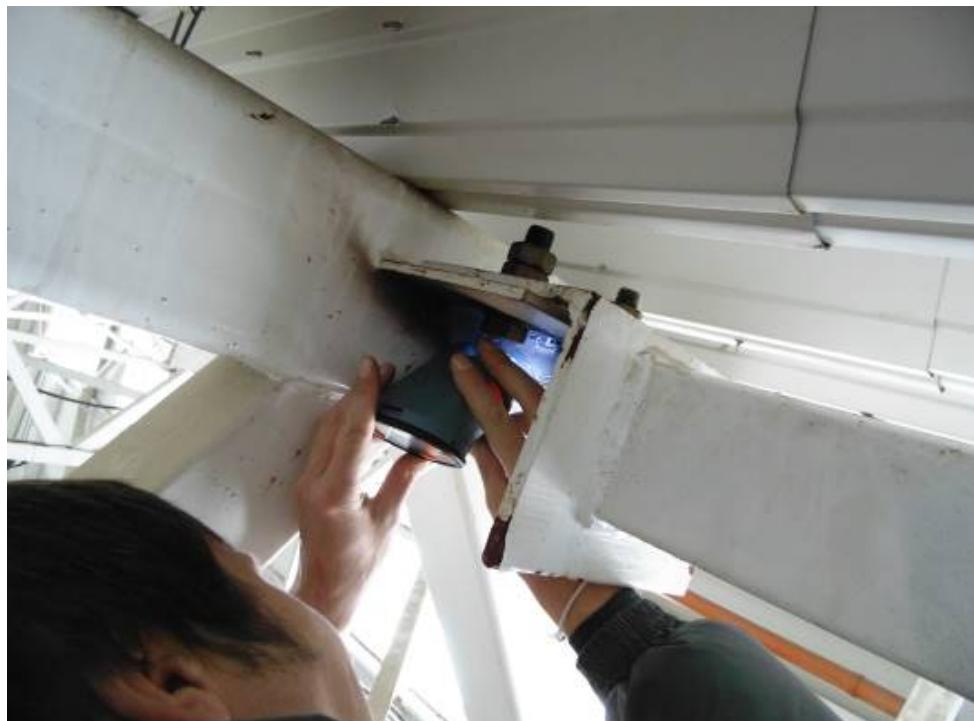
Фото 120. Исследования сварного соединения с использованием фотомикроскопа.
