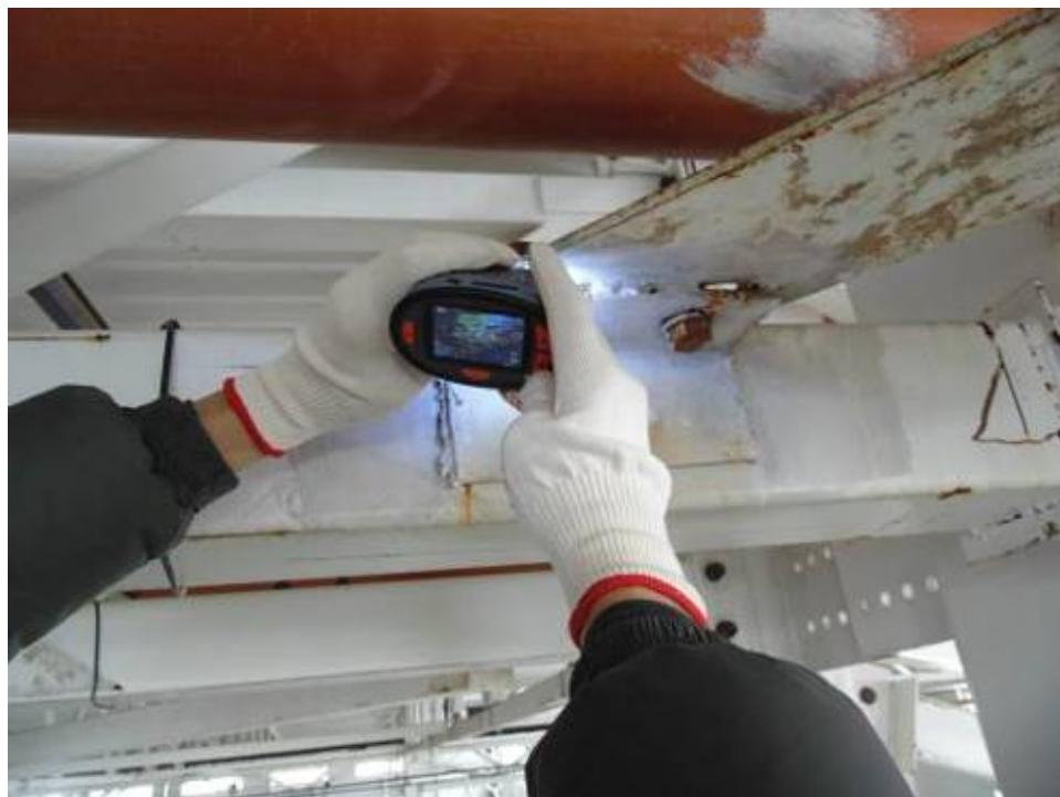
Фото 135. Обследование сварного соединения с использованием фотомикроскопа.
