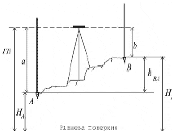
Рисунок 1 - Схема геометрического нивелирования с середины
